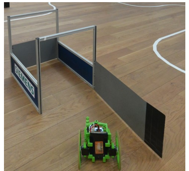
Figur 6: Tunnel med den brede dør åben. Dørene er af 1.5mm jernplade og åbnes begge udad.
