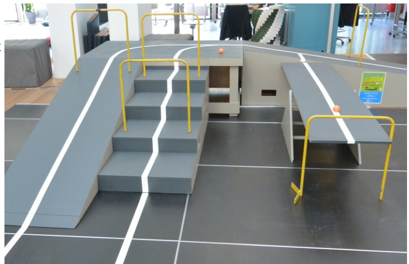
Figur 4: Rampe, plateau, trappe og vippe. De orange golfkugler på plateauet og vippe er netop synlige. Gulvet er sorte felter med smalle aluminiumskanter.
