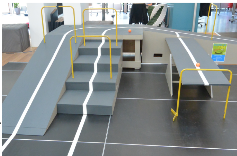
Figur 4: Rampe, plateau, trappe og vippe. De orange golfkugler på trappe og vippe er netop synlige. Gulvet er sorte felter med smalle aluminiumskanter.
